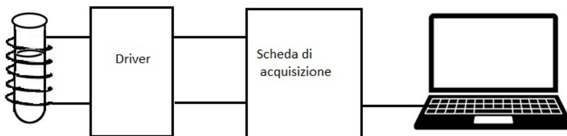
Schema di principio per l'irradiazione della soluzione acquosa di DNA con segnali elettromagnetici
