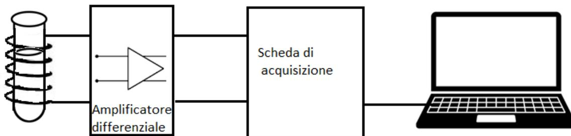
Schema di principio per il rilevamento e la memorizzazione dei segnali emessi dalla soluzione acquosa di DNA.
